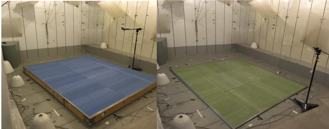
(Billedtekst: Opsætning af akustiske målinger jf. DS/EN ISO 354:2003 med hhv. monteringsstype A (Højre) og monteringsstype E (Venstre))
